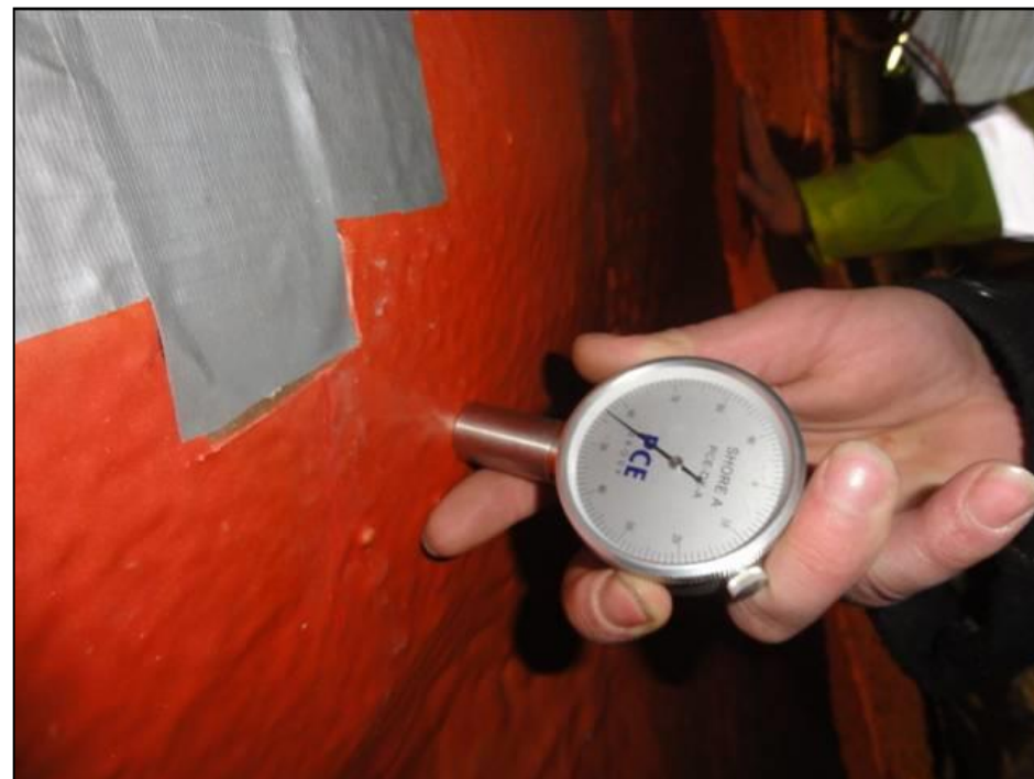
Zkouška tvrdosti podle Shore A (bezrozměrná veličina)
