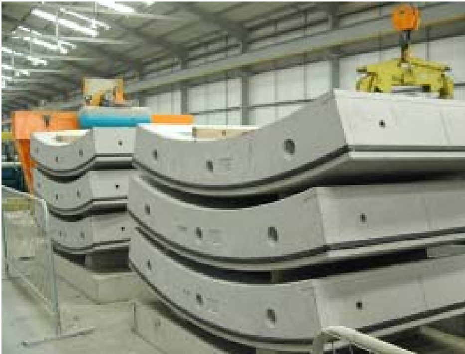
Prutová výztuž nahrazena ocelovými vlákny (drátky)
