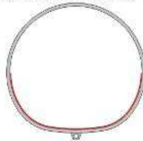
1. Hydroizolace spodní klenby
